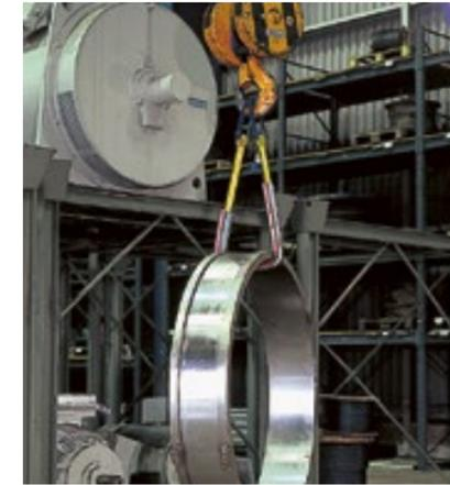
PowerStar – Hebeband mit „nachmessbarer“ Tragfähigkeit
