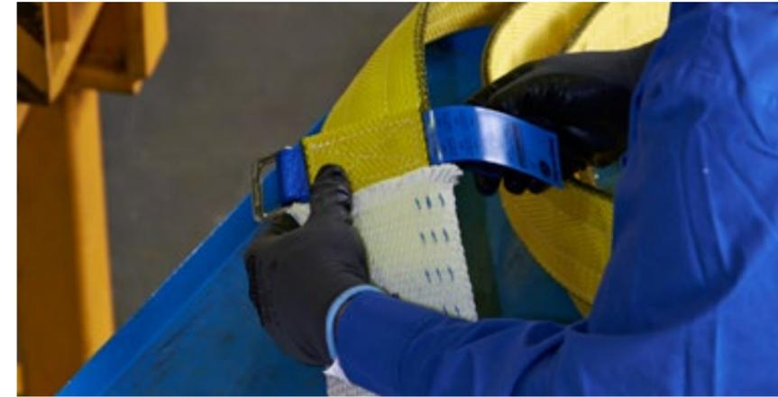
NoCut® pad – Schutzplatten gegen die „Scharfe Kante“
