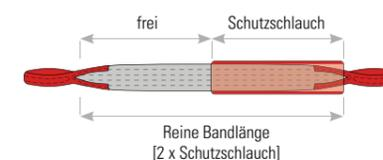
**i** Beim Aufrichten/Wenden mit **NoCut sleeve** eine Überlappung von mindestens **+20 % der Schlauchlänge** nutzen.
