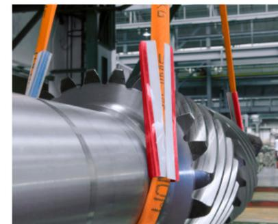
Schiebt sich die Last in seitliche Richtung, entsteht eine schneidende Bewegung an der Kante. Vergleichbar mit der Klinge eines Messers, kann die Kante die Fasern des textilen Hebemittels durchtrennen.
