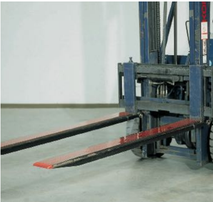
Unten offen, geschweißte Profi-Ausführung, Beschichtung oben + seitlich
