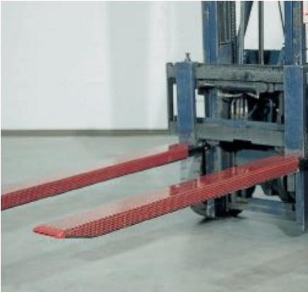
Unten geschlossen, Beschichtung oben
