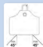
Ablenkwinkel der Last/ Deflection angle/ Angle de dérivation
