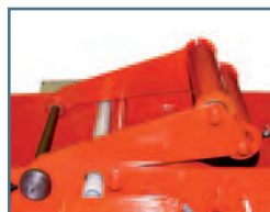
Schlaffseilschalter (3) Slack-rope switch (3) Détection de brin mou (3)
