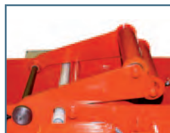
Schlaffseilschalter Slack-rope switch Détection de brin mou
