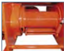
Seilandruckrolle Pressure roller Rouleau presse cable
