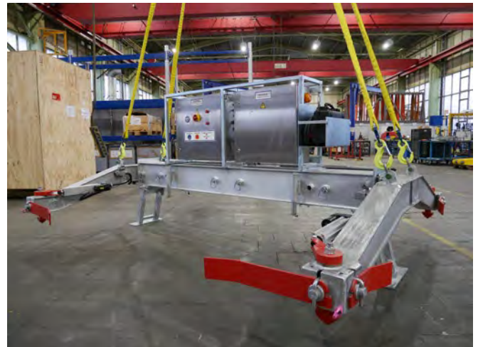
Containertraverse für 10-, 16- und 20-Fuß-Container Teleskopierbare Bauweise mit elektromechanischer Twistlockverriegelung
