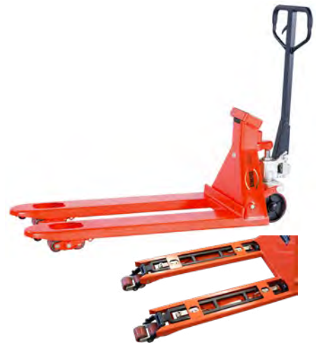
Vier in den Gabeln eingebaute Wiegezellen sorgen auch bei ungünstigen Lastenlagen oder Bodenverhältnissen für präzises Wiegen!
