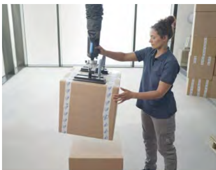
FORCE-LIFT®: Der stärkste Einhandschlauchheber auf dem Markt überzeugt mit intuitiver Steuerung und ermöglicht dynamisches Handling unterschiedlichster Materialien.
