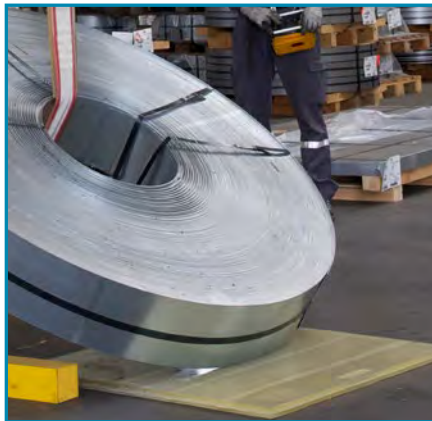
secutex-Wendematte zum Wenden von Coils
