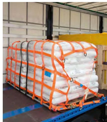
Netz mit Kopflashing
