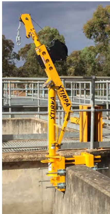
Flexible Sicherung für Behälter und Becken in Wasser- und Klärwerken – einsetzbar, wo technische oder wirtschaftliche Fixpunkte fehlen. Kombinierbar mit verschiedenen Masten, für Klemmbereiche von 0-1143 mm.
